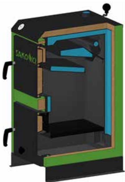
Рис.1 Разрез котла SAKOVICH STANDART
